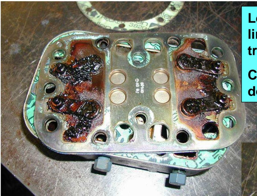
**Le compresseur fonctionne en dehors de ses limites d'utilisation, température de refoulement trop élevée.**
